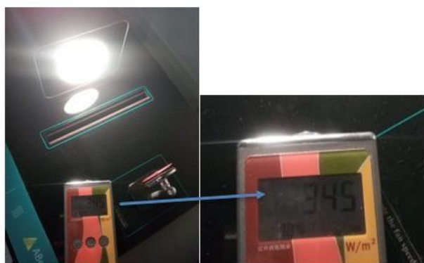
Gambar 9 . Glass Thermal Insulated Test (Kondisi Tanpa Kaca)
