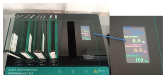
Gambar 6 . Alat Uji - Comprehensive Performance Test (Kondisi Tanpa Kaca)
