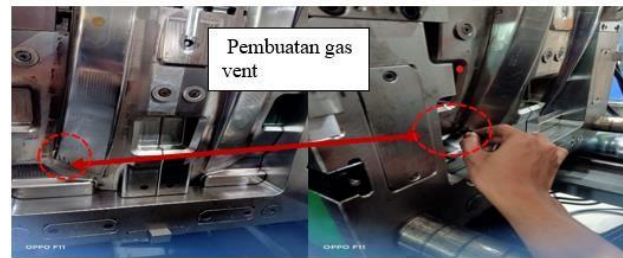
Gambar 6. Tidak ada gas vent di area rib bagian core Mold
