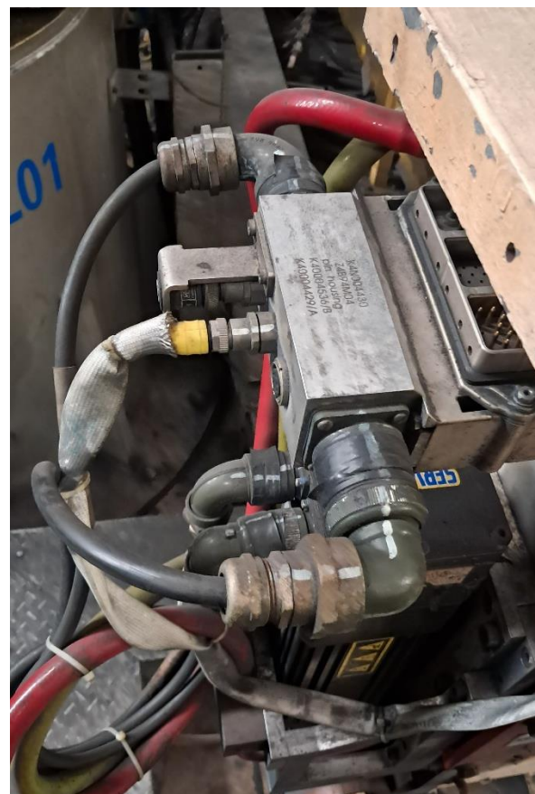
Gambar 3. Tool changer Pada Gun
