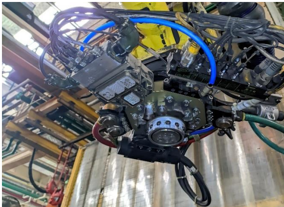
Gambar 4. Tool changer Pada Robot
