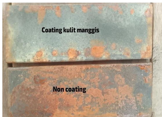
Gambar 16. Perbandingan coating manggis dan non coating , sesudah direndam di dalam larutan NaCl.
